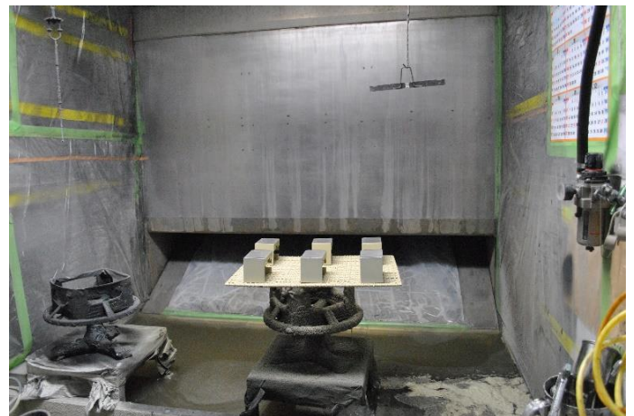
中央の棚にワークがのっかっています。奥の隙間から風を吸い込みます
